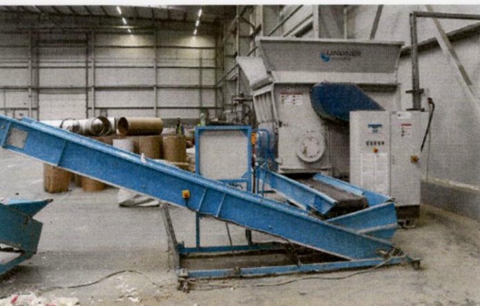
Mimo kompaktowej budowy, rozdrabniacz Lindner Antares 1300 może mieć bardzo szerokie spektrum zastosowań, wynikające m.in. z wielu dostępnych opcji umożliwiających łatwe przystosowanie maszyny do konkretnych potrzeb.
